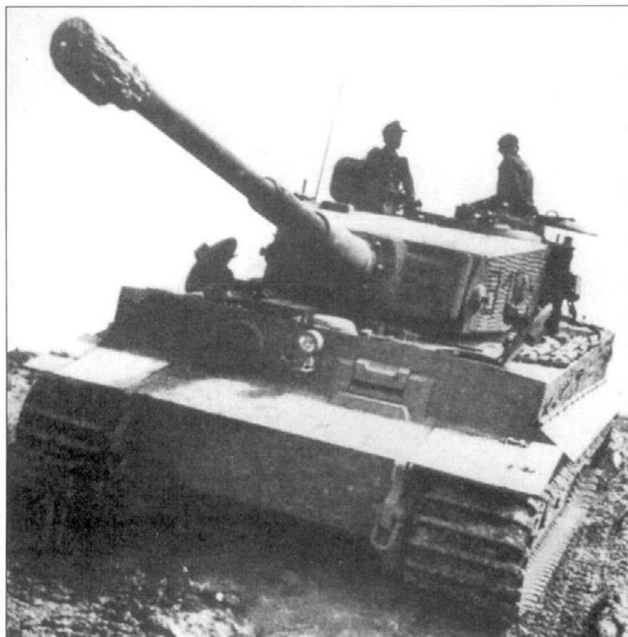
«Тигр» с бортовым кодом «А12», на ходовую часть одеты узкие транспортные гусеницы.
