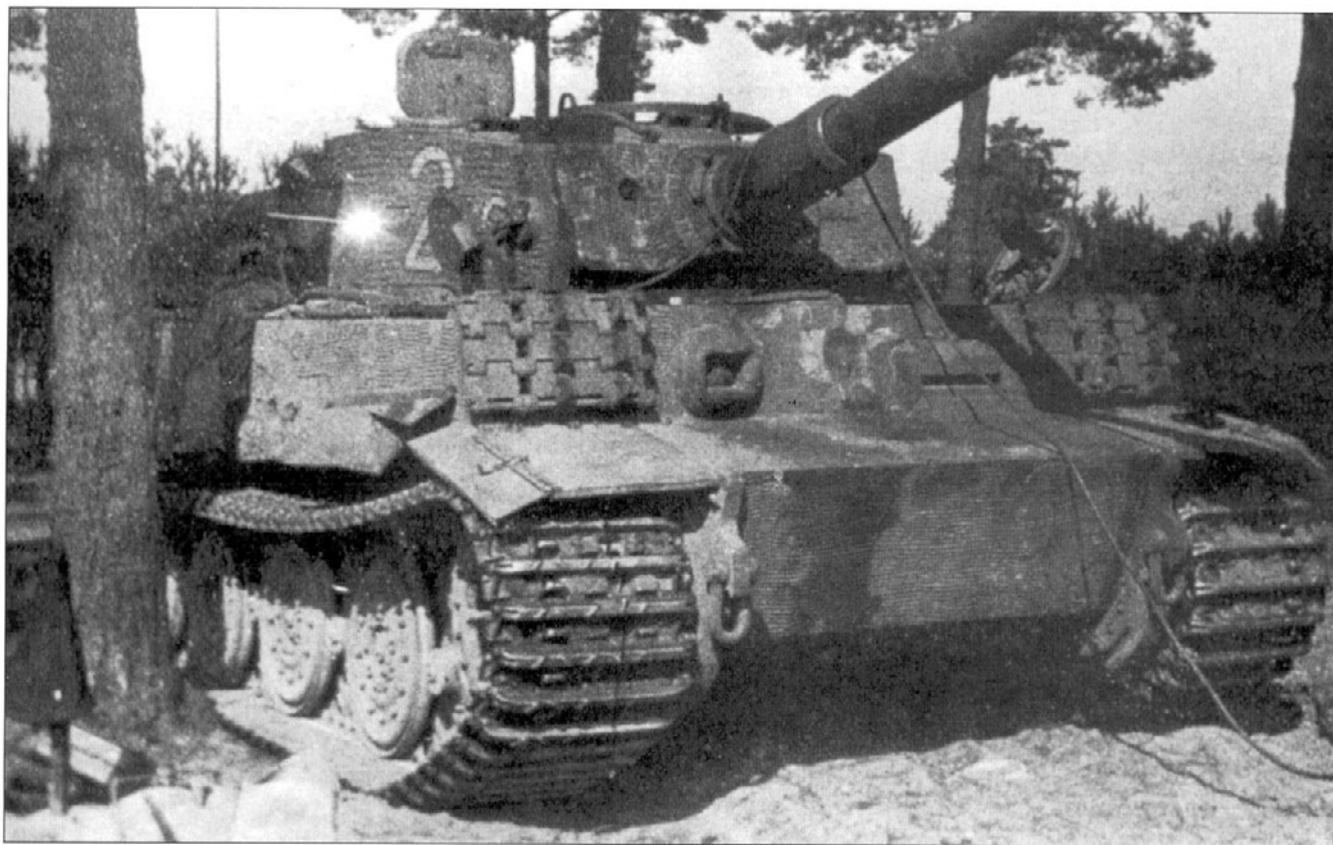
Танки постоянно ремонтировали. На снимке - механик заваривает пробойну в борту башни «Тигра».
