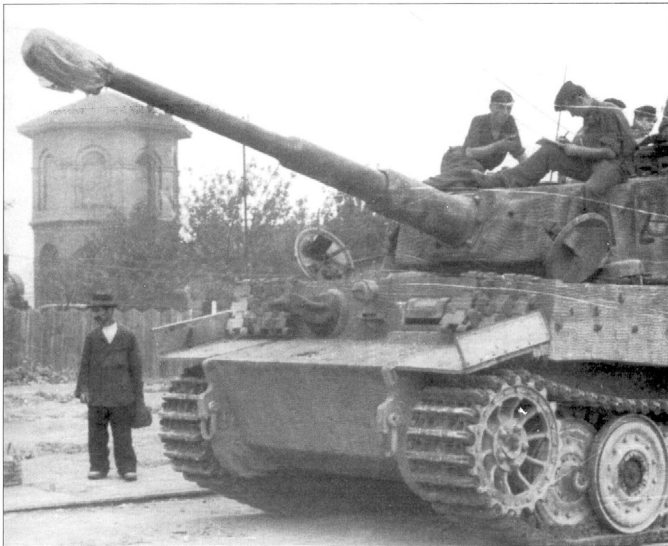
«Тигр» с бортовым кодом «А12», на ходовую часть одеты узкие транспортные гусеницы.
