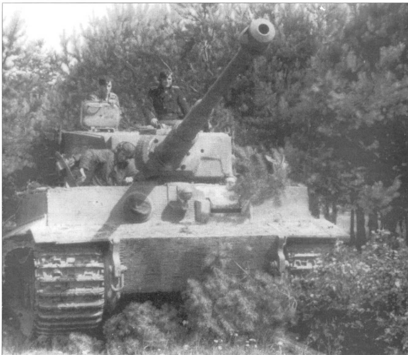
На этом снимке хорошо видна фактура циммеритной обмазки «Тигра». Фотография сделана севернее Варшавы. Рота принимала участия в боях с польскими повстанцами.
