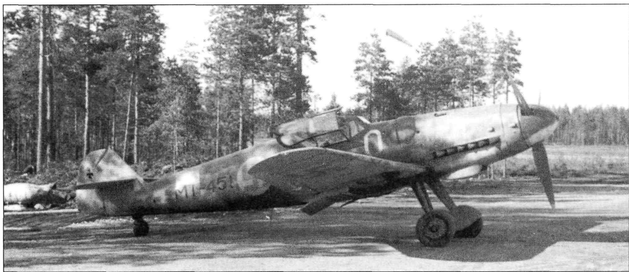
Истребитель Bf.109G-6/R-6 (бортовой код «MT-451»), аэродром Тайналсаари, июнь 1944 г. Обратите внимание - крыльевые пушки сняты и с этого «ганбота». Самолет принадлежал I/НLeLv-34. На этой машине командир HLeLv-34 майор Эйно Луукканен 5 августа 1944 г. занес на счет эскадрильи последнюю победу в воздушной войне, сбив над Финским заливом истребитель Як-9.
