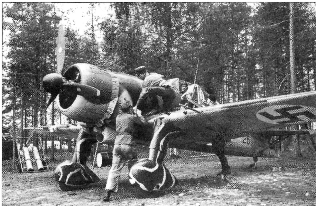
Механики запускают инерционным стартером двигатель истребителя Фоккер D.XXI с бортовым кодом «FR-125» из 2/LeLv-30, аэродром Хивинкя, 11 июля 1941 г. Тремя днями ранее на этом самолете открыл свой боевой счет 2-й лейтенант Тури Маттила. Обратите внимание на характерную камуфляжную окраску обтекателей основных опор шасси.
