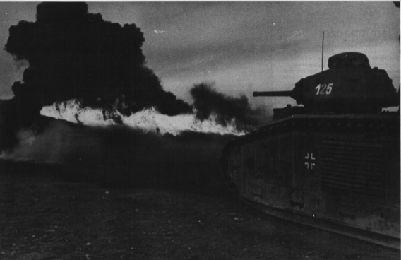
Auch einige der im Frankreichfeldzug erbeuteten schweren Panzer "Char" B1 wurden zu Flammpanzern umgebaut und eingesetzt. Man hatte dabei die 7,5 cm Haubitze in der Fahrzeugfront durch die Flammdüse ersetzt (BA)
