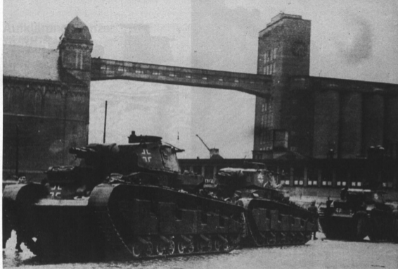
Dieses Bild zeigt alle drei Fahrzeuge kurz nach dem Ausschiffen. Sie sollten das Vorhandensein einer größeren Zahl schwerer Panzer vortäuschen und wurden deshalb häufig abgelichtet. Wegen der schwachen Panzerung (13 – 20 mm) war der Kampfwert der Fahrzeuge jedoch gering
