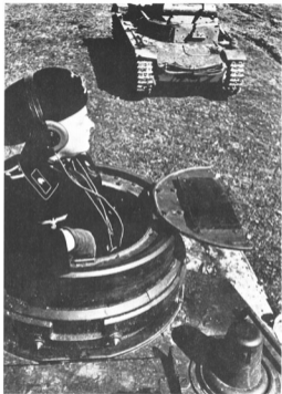
Dieses Foto zeigt Einzelheiten der Kommandantenkuppel eines III/D. Im Hintergrund ein Panzer II, vermutlich der Ausführung A.
