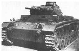
Links oben: Panzer und Grenadiere in der Steppe Südrußlands. Nach dem Triebrad (runde statt ovale Löcher) ist er eine Ausführung G.
