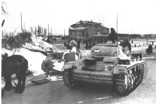
Eine Ausführung G mit Wintertarnanstrich, Rußland, Winter 1941/42. Interessant auf dem Fotot ist auch der prollerangetriebene Kabinenschlitten - hier allerdings von Pferden gezogen.
