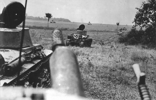
Die Reserve-Kp folgt in Reihe. Das Loch für das Handperiskop ist im Deckel am linken Bildrand zu erkennen.
