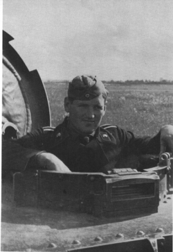
Panzerkommandant Unteroffizier Sprenger der 1./Pz.Abt. 65 im Turmeinstieg seines Skoda 35 (t). Gut zu erkennen sind die Niete und im Turmdeckel das Lederpolster. In ihm blieb manch Geschöß oder Splitter stecken, wenn der Deckel nicht rechtzeitig geschlossen werden konnte. Die Niete zeigten sich als ungünstig, wenn ein stärkeres Panzergeschöß schräg die Panzerplatten traf und diese zum Federn brachte. Die hierdurch abgebrochenen Niete flogen im Kampfraum herum und trafen die Besatzung.
