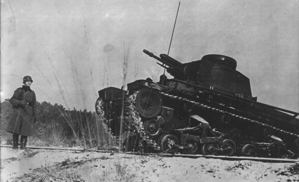
Ein Panzer der 1./Pz.Reg. 11 mit einer interessanten Rohrhalterung oberhalb der Kettenabdeckung. Sie diente zum Befestigen von zusätzlichen Betriebsstofftanks, persönlicher Habe der Besatzung und der "Freßkiste" - zumeist eine leere Munitionskiste, in der Verpflegung mitgeführt wurde.
